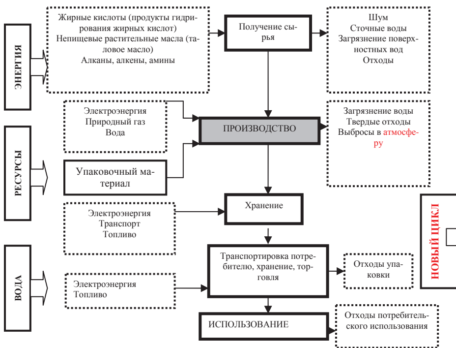
Рис. Основные этапы жизненного цикла и наиболее важные экологические аспекты производства и потребления моющих средств [4]
