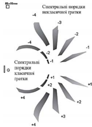
Рис. 3. Просторове розташування площиноподібних просторів найкращого фокусування в різних спектральних порядках для класичної та неklasичної сферичних дифракційних ґраток у спектральному діапазоні 200 — 350 нм. Квадрат 20x20 мм вказує масштаб.
