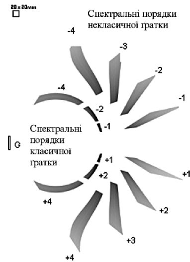
Рис. 3. Просторове розташування площиноподібних просторів найкращого фокусування в різних спектральних порядках для класичної та неklasичної сферичних дифракційних ґраток у спектральному діапазоні 200 — 350 нм. Квадрат 20х20 мм означає масштаб.
