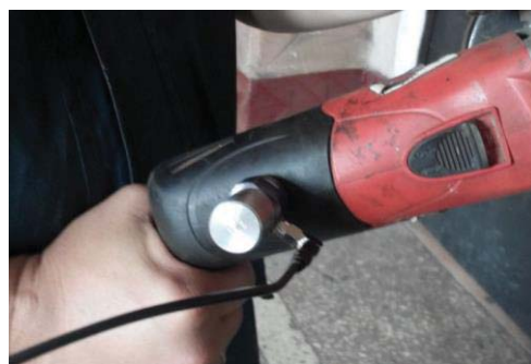
Рис 7. Вимірювання локальної вібрації КШМ
