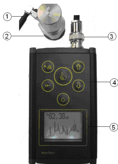
Рис. 7. Віброметр 795M107B: 1 – кабель; 2 – п'єзоакселерометр; 3 – роз'єм; 4 – кнопки управління; 5 – рідкокристалічний дисплей.
