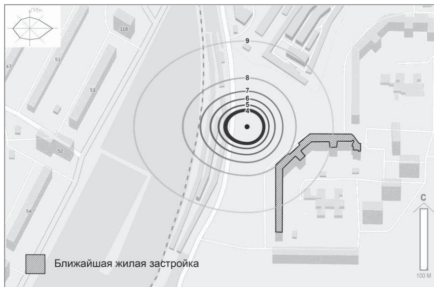
Рис. 2. Карта рассеивания сероводорода, выбрасываемого из канализационной шахты № 11 (Коллектор ХТЗ) в городскую атмосферу
