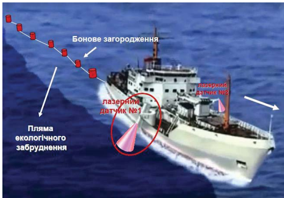
Рис. 2. Метод виявлення й оконтурення плям нафти й нафтопродуктів з використанням спеціалізованого судна з системою лазерних датчиків
