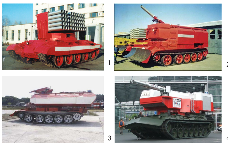
Рис. 4. 1 – гусеничная пожарная машина тяжело-бронированная ГПМ «Импульс-3М» с 50-ствольным модулем распыляющем залпами; 2 – гусеничная пожарная машина легко-бронированная «ГПМ-54» с лафетным стволом 40 л/с, тушит до 20 м, водная цистерна 10 т и 0,3 т пенообразователь, шасси Т-54. 3 – Чешская гусеничная пожарная машина легко-бронированная «SPOT-55» со спаренными, лафетными стволами по 2х60 л/с тушит до 40 м, телеуправление стволами, цистерна 12 т воды, 0,5 т пены. 4 – Германская гусеничная пожарная машина легко-бронированная с башней с «IFEX-3000»-спаренные пневмоимпульсные стволы по 2х20 л/с, компрессор высокого давления, дальность тушения до 40 м, цистерна 10 т воды, шасси "Leopard-1", стоимость 1,5 млн Е.
