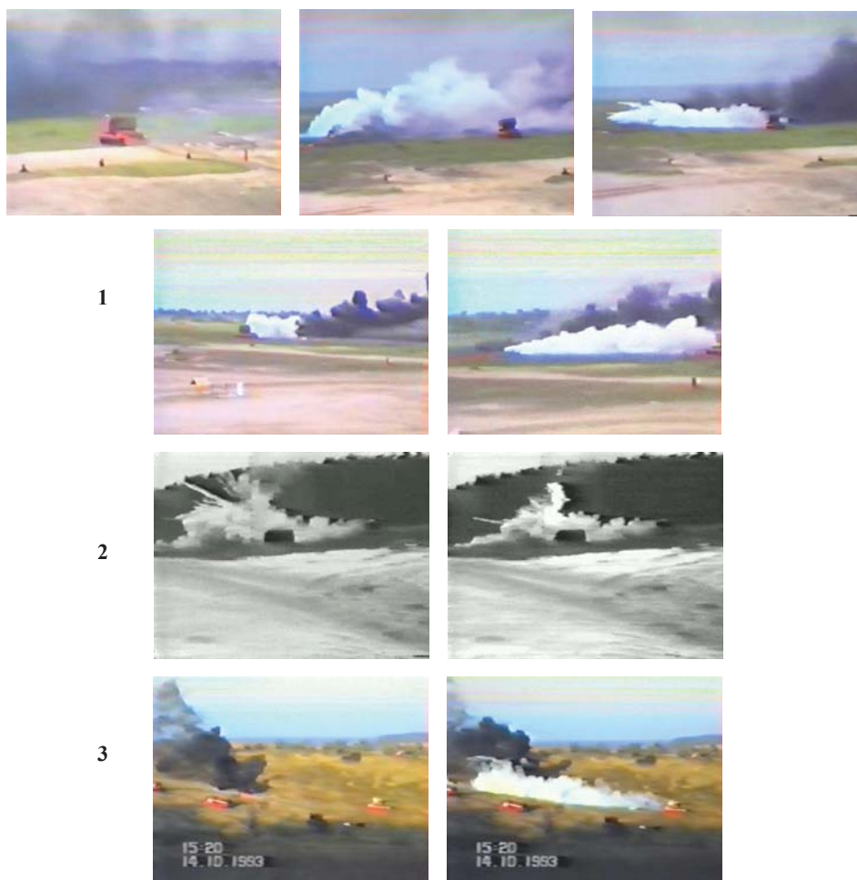
Рис. 5. 1 – тушение площади 2500 м 2 с множественными локальными очагами горящего напалма серией залпов по 3-5 стволов, без перезарядки; 2 – тушение распыленного газового фонтана с раскалёнными металлическими конструкциями разрушенной скважины; 3 – тушение 2х200 м 2 розливов смеси бензина и дизтоплива с дистанции 60 м за 1,5 с
