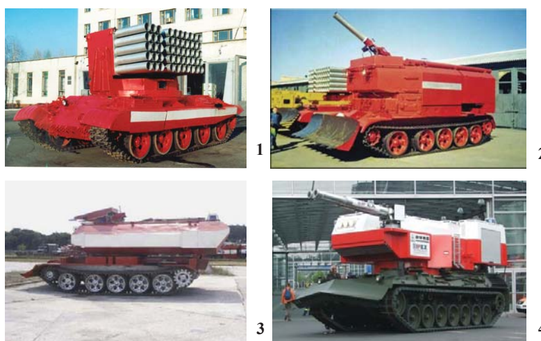
Рис. 4. 1 – гусеничная пожарная машина тяжело-бронированная ГПМ «Импульс-3М» с 50-ствольным модулем распыляющим залпами; 2 – гусеничная пожарная машина легко-бронированная «ГПМ-54» с лафетным стволом 40 л/с, тушит до 20 м, водная цистерна 10 т и 0,3 т пенообразователь, шасси Т-54. 3 – Чешская гусеничная пожарная машина легко-бронированная «SPOT-55» со спаренными, лафетными стволами по 2х60 л/с тушит до 40 м, телеуправление стволами, цистерна 12 т воды, 0,5 т пены. 4 – Германская гусеничная пожарная машина легко-бронированная с башней с «IFEX-3000»-спаренные пневмоимпульсные стволы по 2х20 л/с, компрессор высокого давления, дальность тушения до 40 м, цистерна 10 т воды, шасси "Leopard-1", стоимость 1,5 млн Е.
