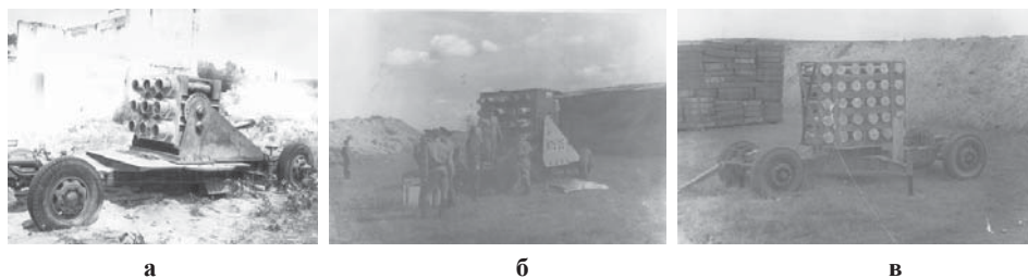
Рис. 2. а – откатный распылительный 9-ствольный модуль на двухосном лафете, залпом распыляет до 180 кг ОП на дальность до 90 м с площадью тушения до 600 м 2 , в – безоткатный 30-ствольный модуль
