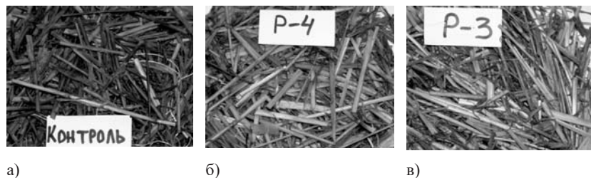
Рис. 1. Термообробка соломистого субстрату в мікрохвильовому полі а) – контроль, б) – обробка протягом 5 хв., в) – обробка протягом 7 хв.
