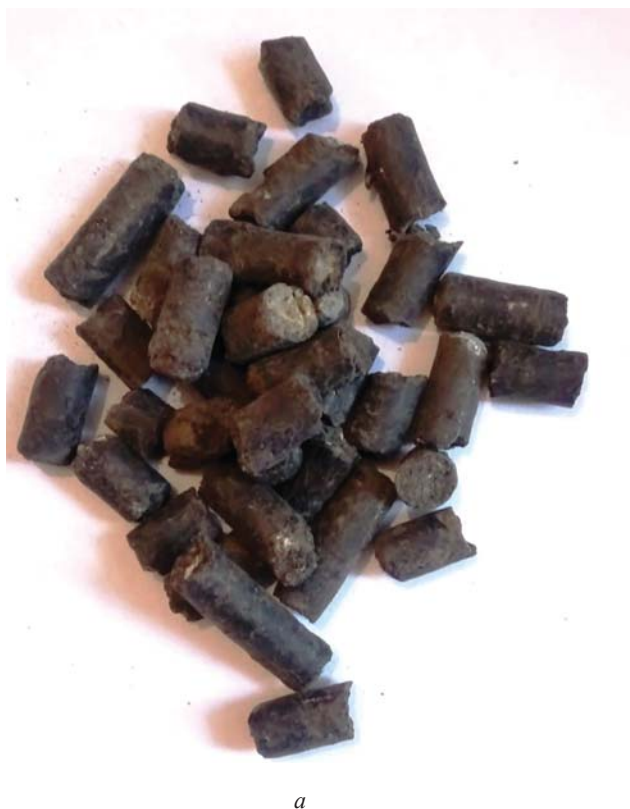
Рис. 6. Зразки гранул донних мулів станції водоочищення м. Івано-Франківська до переробки (а) та після їх газифікації та оплавлення (б)
