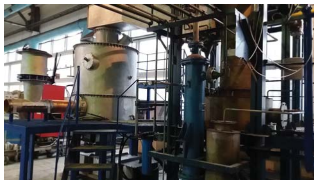
Рис. 3. Загальний вигляд установки для переробки донних мулів із боку системи очищення відхідних газів у процесі випробувань
