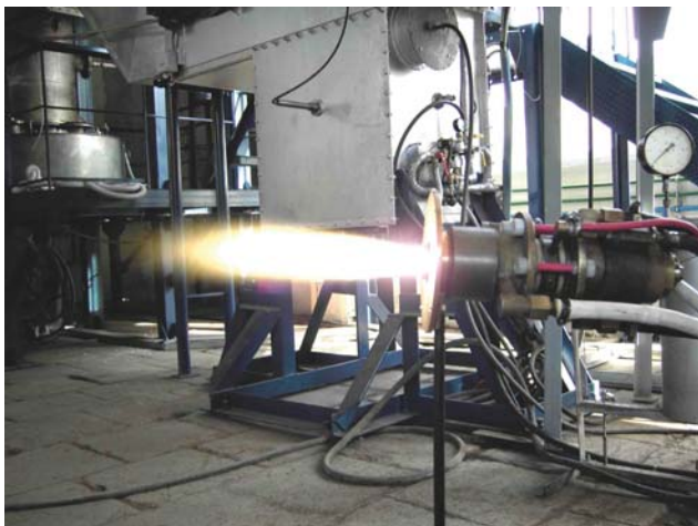
Рис. 2. Пароводяний плазмотрон потужністю 160 кВт у режимі налаштування
