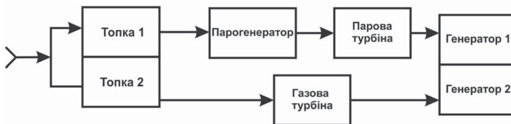
Рис. 1. Блок-схема виробництва електроенергії на базі паротурбінної і газотурбінної установок
