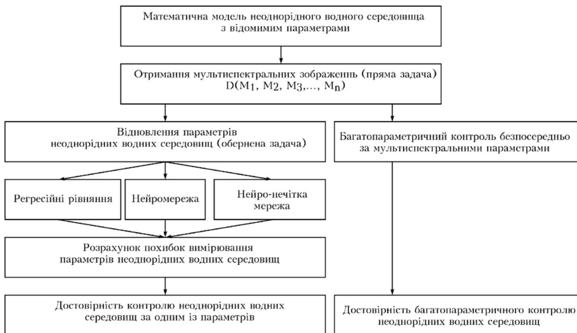
Рис. 2. Схема оцінювання достовірності мультиспектрального контролю параметрів водних середовищ
