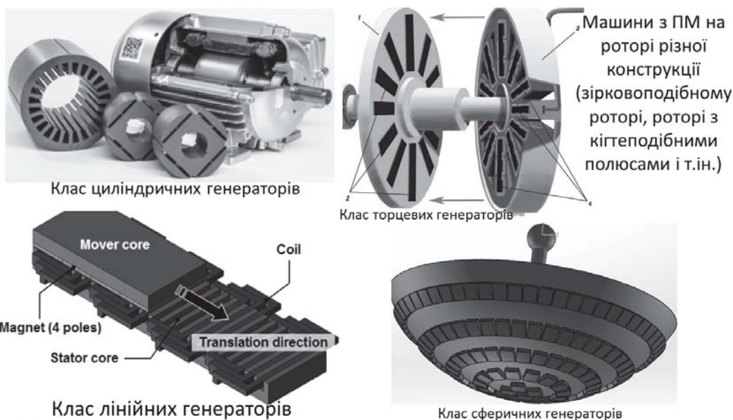
Рис. 4. Класифікація генераторів для вітроустановок за типом джерела електромагнітного поля
