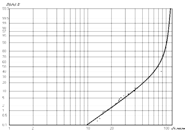
Рис. 1. Графік інтегрального розподілу часток пилу D за діаметрами d_{pe} на ділянці перевантаження доломіту
