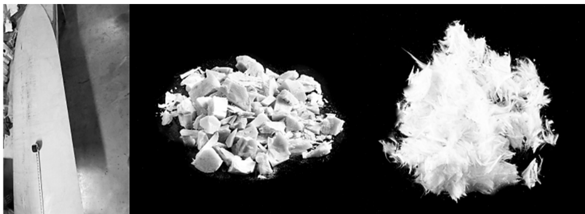
а) процес перероблення лопатей за допомогою піролізу
