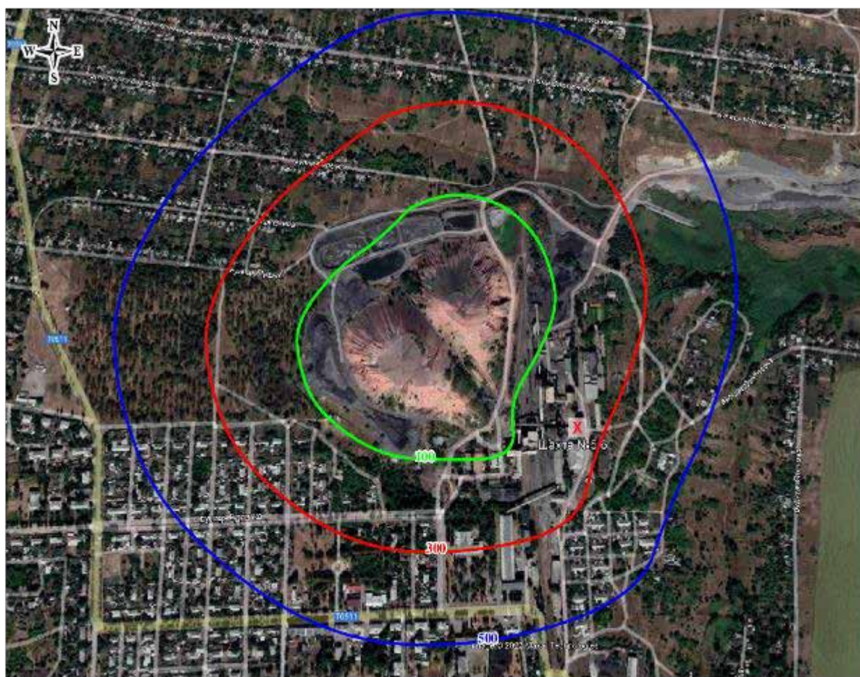
Рис. 6. Ізолінії розповсюдження вуглепородного пилу в атмосферному повітрі в межах території шахти № 5/6 з урахуванням метеорологічних умов
