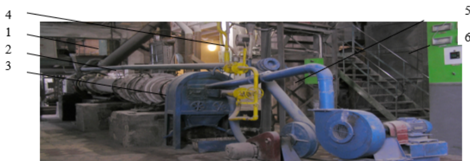
Рис. 5. Загальний вигляд дослідно-промислової обпалювальної печі 1 – відведення димових газів; 2 – обертова обпалювальна піч; 3 – розвантажувальна голівка і паливниковий пристрій печі; 4, 5 – вузол подання природного газу в паливник печі; 6 – вузол вдування ХЗЗР і повітря в паливник печі; 7 – щит КВП і А установки
