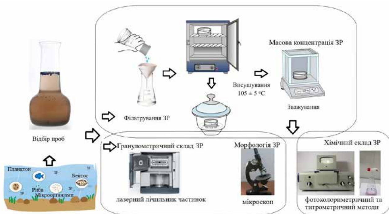
Рис. 3. Схема виконання вимірювань характеристик ЗР
