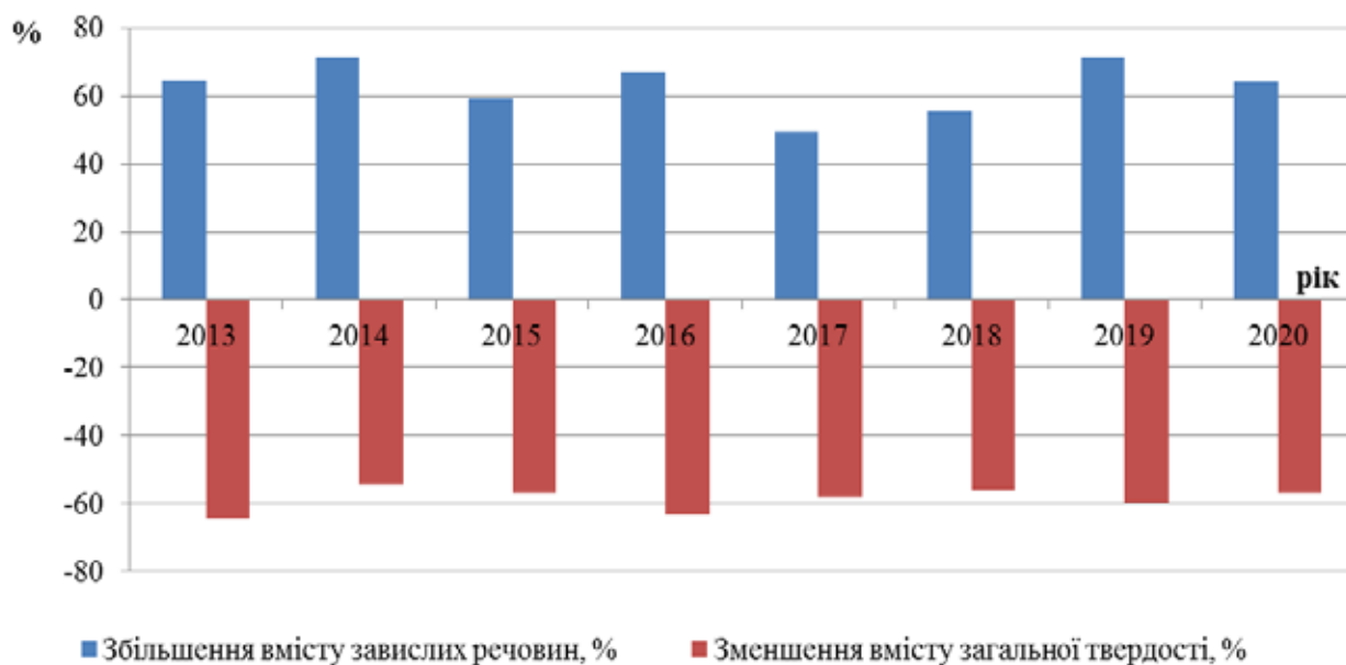
Рис. 4. Збільшення концентрації ЗР та зменшення концентрації ЗТ в освітленій воді в порівнянні з вхідною водою
