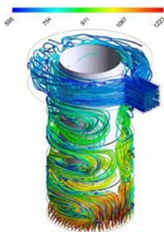
Рис. 5. Напрямки потоку продуктів згоряння в газоході з відображенням температури газів
