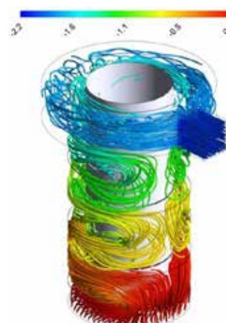
Рис. 7. Напрямки потоку продуктів згоряння в газоході, а також показники втрати тиску
