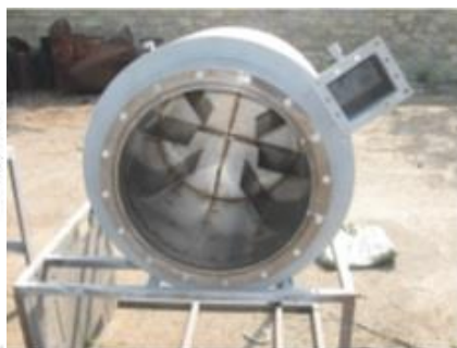
Рис. 3. Конструкції ребер: а – прямі ребра довільної конфігурації в середині реактора; б – кільцеві ребра довільної конфігурації ззовні реактора
