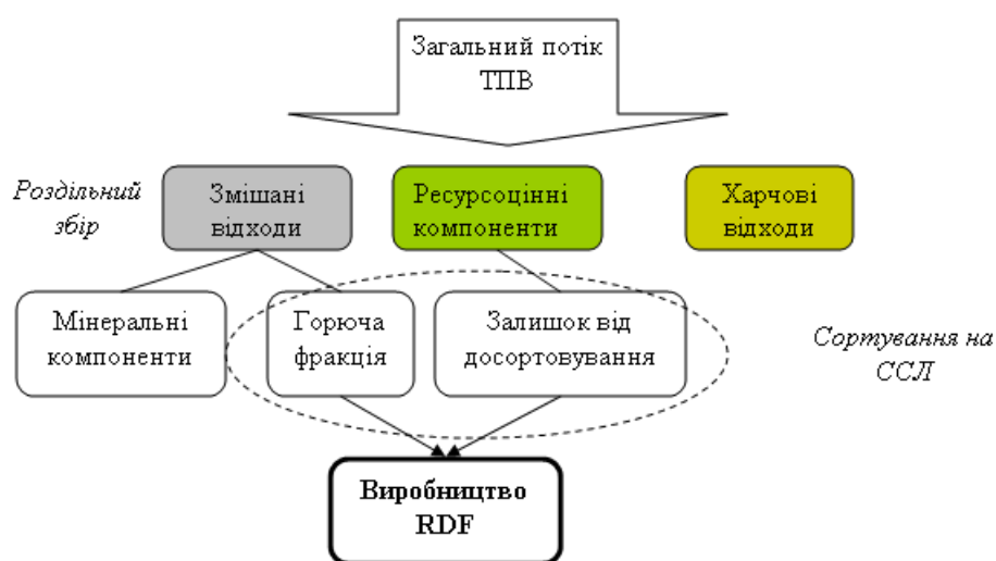
Рис. 3. Схема матеріальних потоків відходів за умови роздільного збирання та досортування на сміттесортувальних лініях
