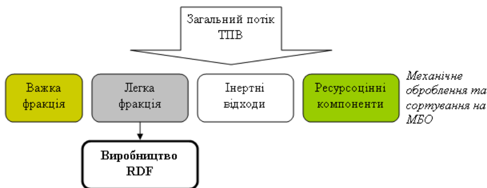
Рис. 2. Диференціація потоку ТПВ на заводах МБО, що працює за технологією відновлення енергії [1]
