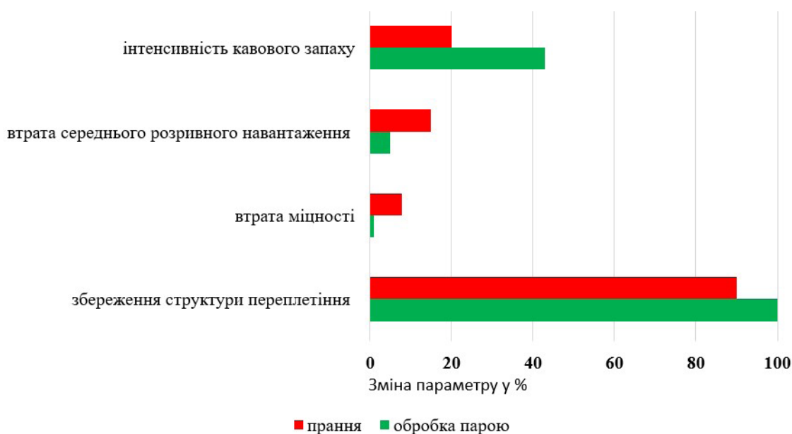
Рис. 2. Порівняльний аналіз впливу методів попередньої обробки на властивості джутових волокон
